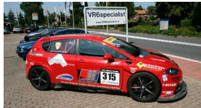
Deze Seat Leon rijdt in de Supercopa en heeft 310 pk en 340 Nm koppel. Inderdaad, met DSG, waar VW ook mee heeft gewonnen tijdens de 24 Uur van de Nürburgring.
