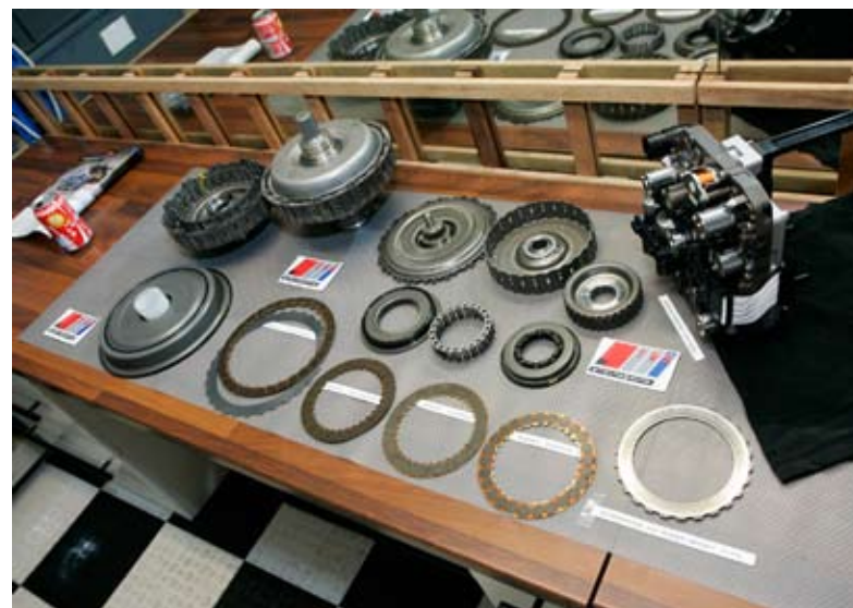
De DSG in onderdelen, met op de voorgrond enkele gemodificeerde koppelingsplaten.
