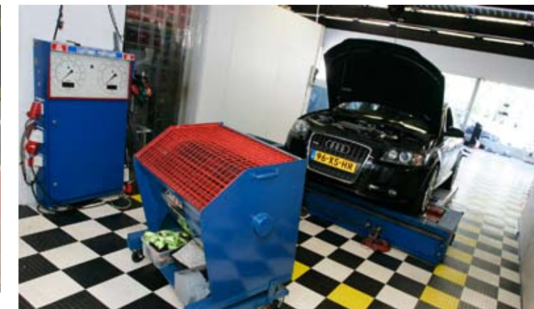
De A3 3.2 V6 turbo op de testbank is goed voor 411 pk en 750 Nm koppel. Met DSG!
